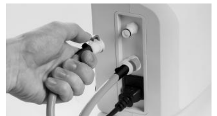
F. Utilizzando i connettori rapidi, collegare i tubi per il gonfiaggio all'unità di controllo - 'nero all'unità di controllo' - assicurandosi che i tubi non siano attorcigliati o piegati.
