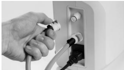
و. باستخدام الموصلات السريعة، قم بتوصيل خراطيم نفخ الهواء بوحدة التحكم - "وحدة التحكم باللون الأسود" - للتأكد من أن الخراطيم ليست ملتوية أو متعرجة.
