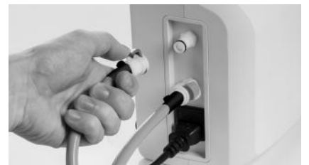
F. À l'aide des connecteurs rapides, raccordez les flexibles de gonflement au dispositif de commande – « Le noir au dispositif de commande » – en veillant à ce que ceux-ci ne soient ni pliés ni emmêlés.
