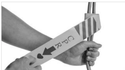
D. Vérifiez que les valves de dégonflage pour RCP sont correctement fixées afin d'éviter toute fuite d'air.
