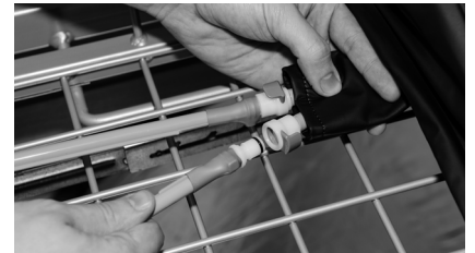
C. À l'aide des connecteurs rapides, raccordez les flexibles utilisés pour le gonflement aux flexibles des cellules d'air – « Le rouge avec le rouge » – en veillant à ce que ceux-ci ne soient ni pliés ni emmêlés.
