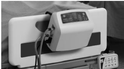
هـ. باستخدام خطافات السرير، قم بتعليق وحدة التحكم على لوح السرير.
