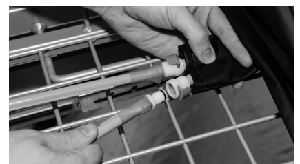
C. Met behulp van de snelsluitconnectors sluit u de luchtopblaasslangen aan op de luchtcelslangen – ‘rood op rood’ – waarbij u zorgt dat de slangen niet verdraaid of geknikt raken.
