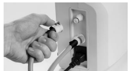
F. Utilice los conectores de acoplamiento rápido para conectar los tubos de inflado a la unidad de control (negro a unidad de control), asegurándose de que no se enreden ni se pincen.
