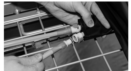
C. Verbinden Sie die Luftzufuhrschläuche über die Schnellanschlüsse mit den Schläuchen der Luftkammern („Rot zu Rot“) und achten Sie darauf, dass die Schläuche nicht verdreht oder geknickt sind.
